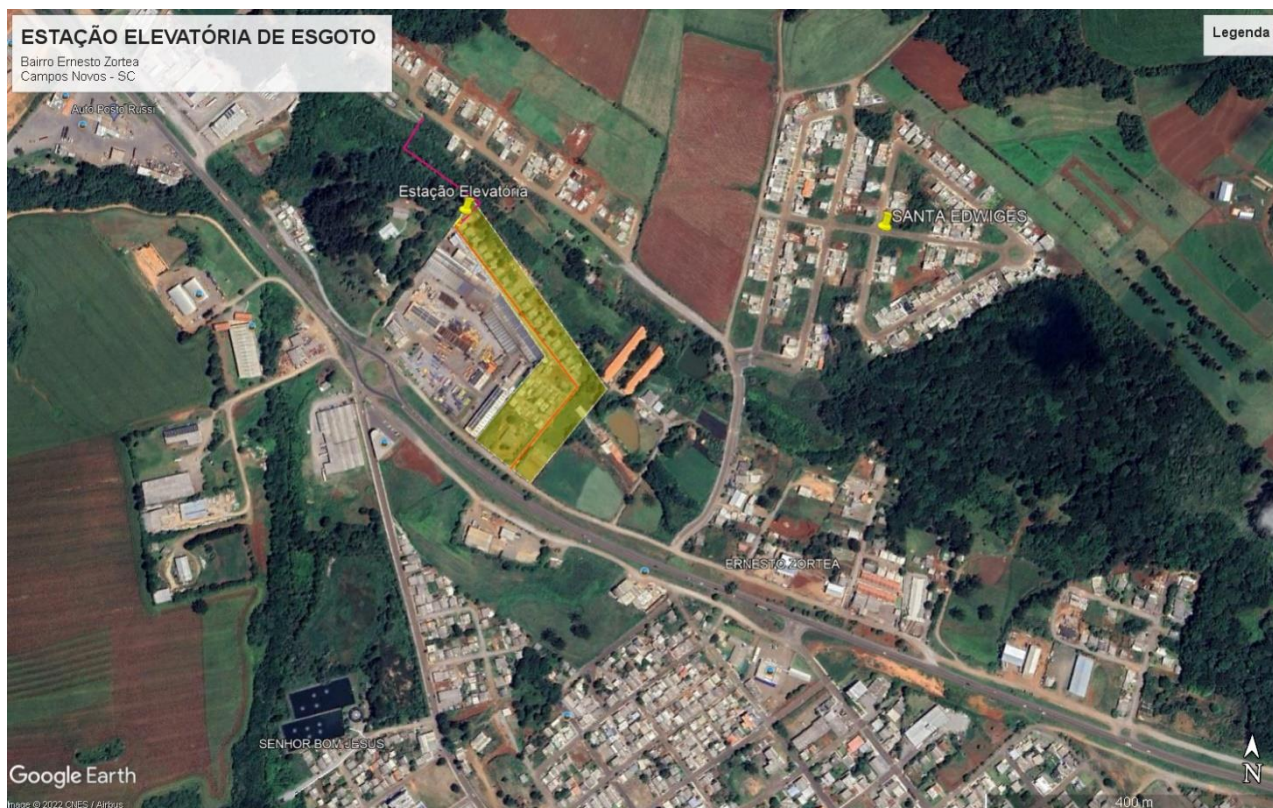
Imagem 1 – Área de contribuição e localização da estação elevatória de esgoto
