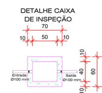
**DETALHE CAIXA DE INSPEÇÃO**
