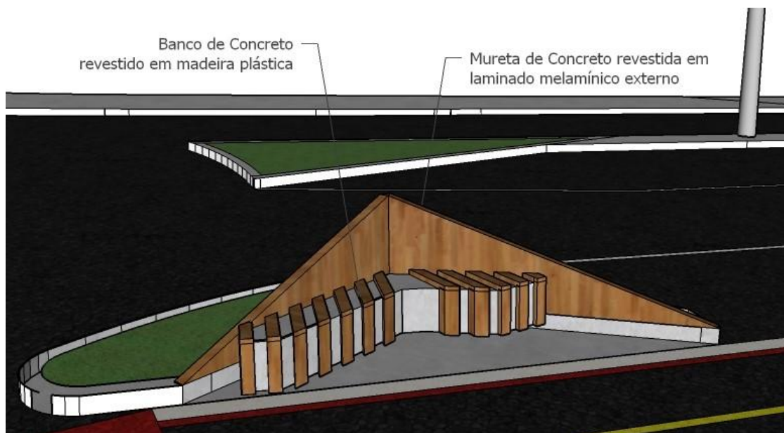
Fig. 04 Modelo do Banco em concreto
